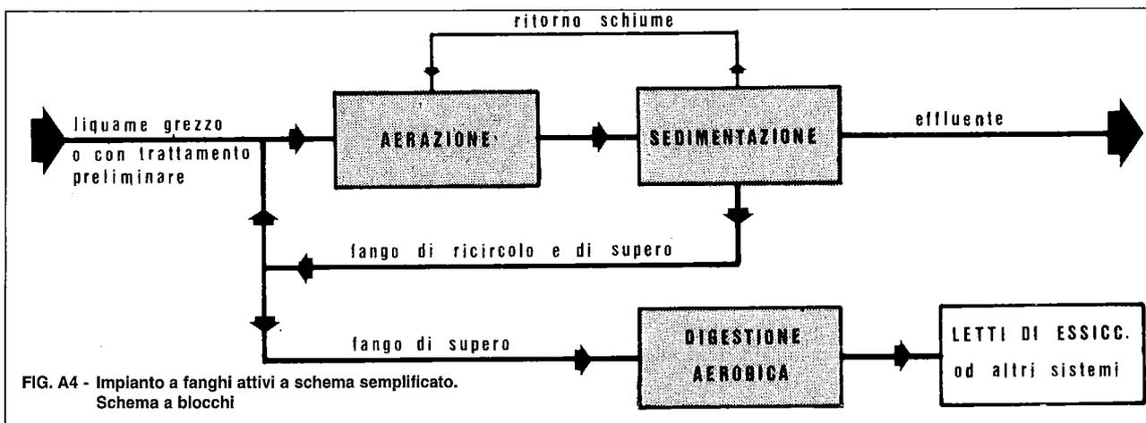
FIG. A4 - Impianto a fanghi attivi a schema semplificato. Schema a blocchi
