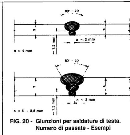
**FIG. 20 - Giunzioni per saldature di testa. Numero di passate - Esempi**
