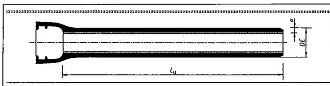
Tutti i tubi dovranno portare, ottenuti di fusione o riportati con pittura o stampaggio a freddo, i contrassegni relativi al marchio di fabbrica, all'anno di fabbricazione, al tipo di ghisa (nel caso, sferoidale) e al diametro nominale DN; inoltre il riferimento alla norma UNI EN 545 ed, eventualmente, la classe di spessore (se diversa da k9) e l'identificazione della certificazione da parte di terzi.
