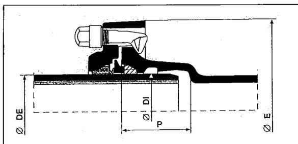
FIG. 29 - Giunto elastico antisfilamento di tipo automatico (rapido) con guarnizione a inserti metallici
