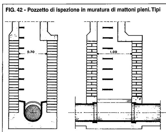
(1) La limitazione di 30 m nella distanza massima tra due pozzetti di ispezione è riferita più propriamente alle fogne di sezione medio-piccola, nelle quali di solito scorre una modesta portata. Per canali in cui fosse prevista una portata continua notevole, la distanza massima potrà anche essere maggiore e, ove non particolarmente stabilita in progetto, verrà fissata dalla Direzione Lavori.
