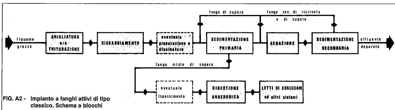
FIG. A2 - Impianto a fanghi attivi di tipo classico. Schema a blocchi
