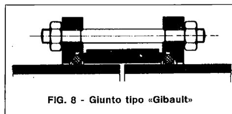
FIG. 8 - Giunto tipo «Gibault»
