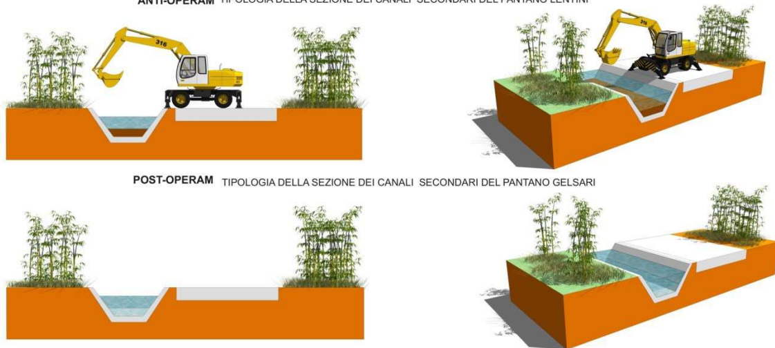
fig. 9_ PARTICOLARE DELLE TIPOLOGIE PER LA PULITURA CANALI DI SCOLO DEL PANTANO LENTINI
